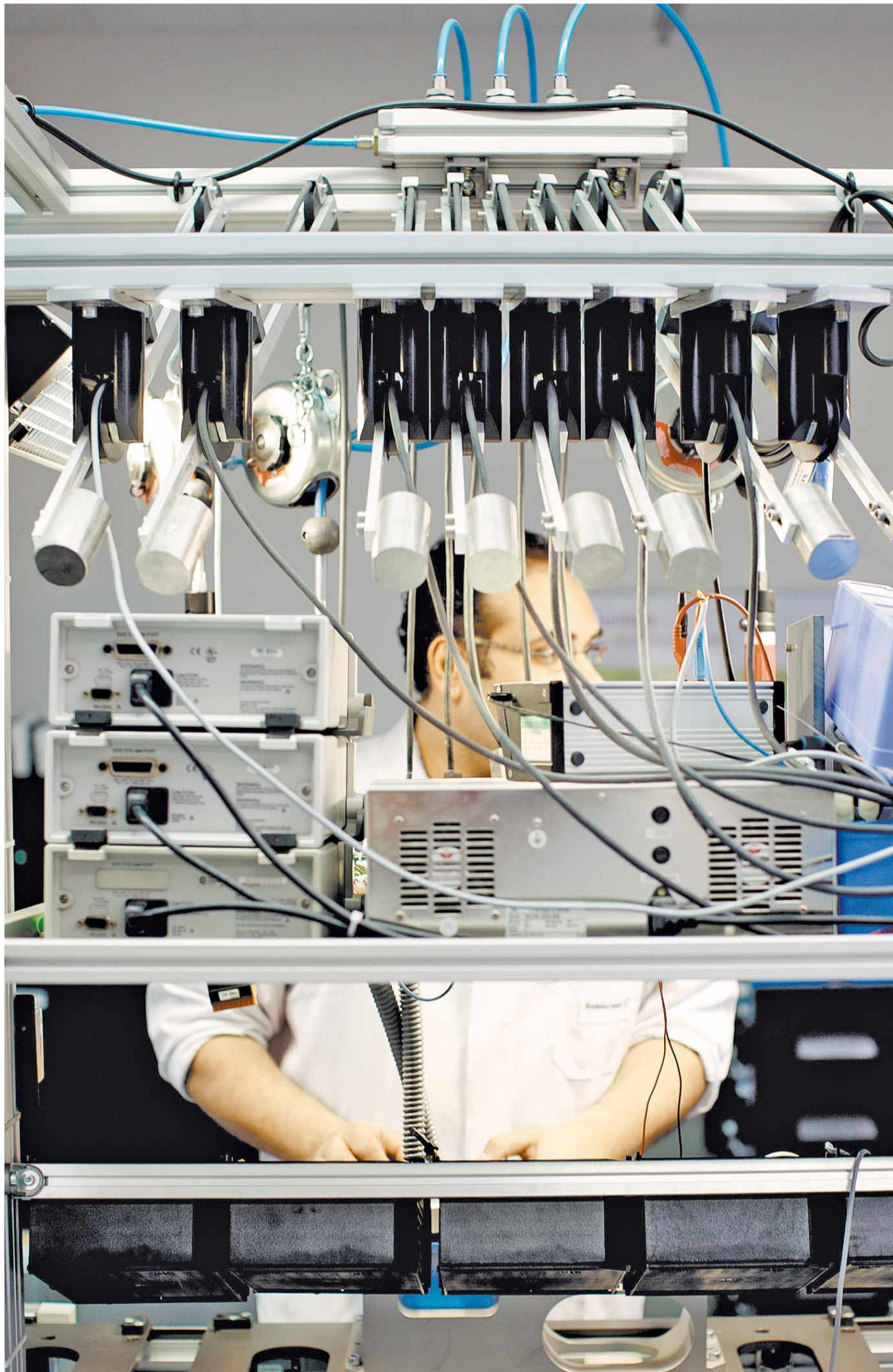
Messtechnische Meilensteine: In der Endmontage von E+H Conducta in Gerlingen wird ein sogenannter Messumformer zusammgebaut, mit dem unter anderem pH-Wert sowie Leitfähigkeit überwacht werden können. Eingesetzt wird das Gerät etwa in der Pharmaindustrie
